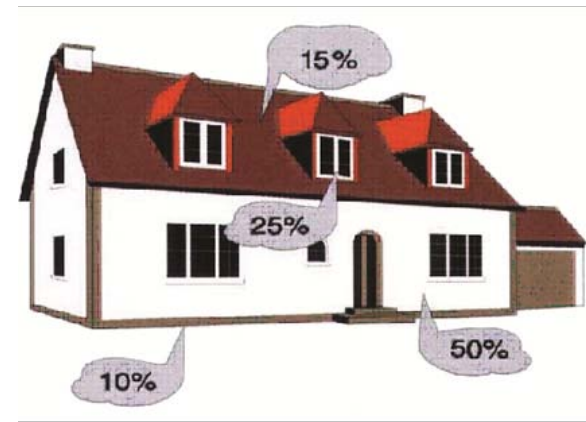
Рисунок 1. Потери тепла через конструкции дома.
