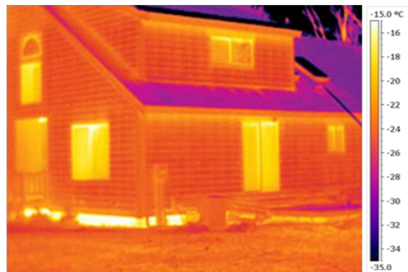
Рисунок 2. Тепловизионная съемка коттеджа.
